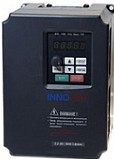
Частотный преобразователь, мощность 110 кВт, 210 А, 3-фазы 380В, 50/60 Гц, -10...+40С, IP20, мощность подключаемых двигателей 30-110 кВт, перегрузочная способность 315 А
