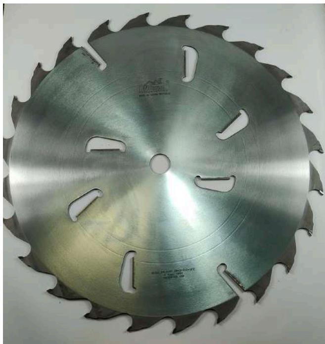
Дисковые пилы Pilana с твердосплавными напайками предназначены для продольного распила сырой, мороженой, естественной влажности древесины всех типов пород. Применяются на многопильных станках – деление лафета (двуухкантного бруса) на обрезные пиломатериалы (брус и доски) и горбыль.
