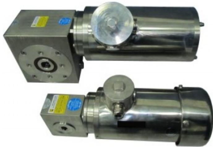
Червячные мотор-редукторы из нержавеющей стали выпускаются с межосевым расстоянием 45, 50, 63, 85 мм. В более широком диапазоне передаваемых моментов доступны стандартные червячные редукторы в антикоррозийном исполнении - выходным валом и болтами из нержавеющей стали, специальной смазкой и окраской корпуса, вайтоновыми сальниками.
