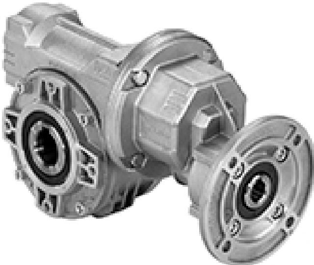
Червячно-цилиндрические мотор-редукторы в алюминиевом корпусе – модернизированная версия червячных мотор-редукторов. Применяется там, где необходимо реализовать большое передаточное отношение и больший момент, также их применение целесообразно при неравномерной нагрузке, в тяжелых динамических условиях, при старт-стопном режиме.
