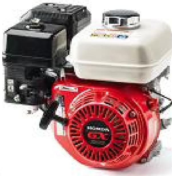
Двигатель Honda серии GX, 4-тактный верхнеклапанный бензиновый двигатель с системой воздушного охлаждения, цилиндром, расположенным под углом 25°, горизонтальным коленвалом и газораспределительным валом нижнего расположения - OHV.
