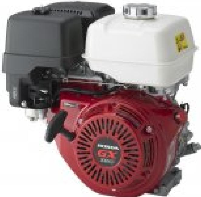
Двигатель Honda серии GX, 4-тактный верхнеклапанный бензиновый двигатель с системой воздушного охлаждения, цилиндром, расположенным под углом 25°, горизонтальным коленвалом и распределительным валом нижнего расположения - OHV.
