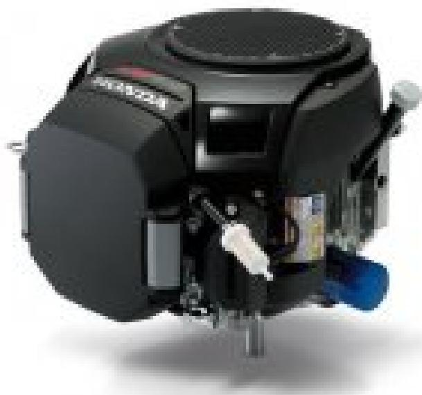
4-тактный верхнеклапанный бензиновый двигатель серии GXV с системой воздушного охлаждения V - образным блоком с расположением цилиндров под углом 90° и вертикальным коленвалом.
